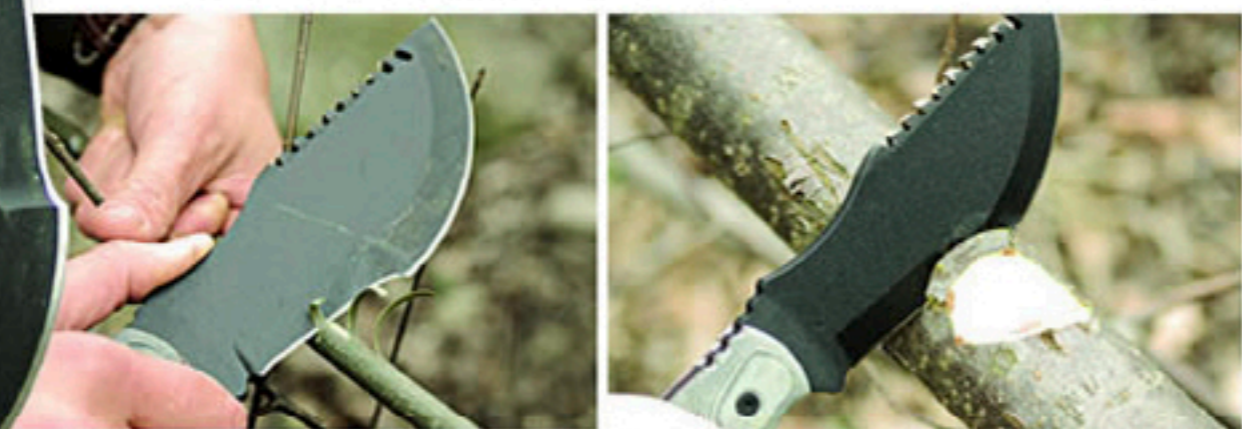
Andere Philosophie: Beim TOPS Tracker ist der hintere Bereich flach geschliffen, der vordere hohl. Auch das funktioniert zwar in der Praxis, doch ganz stimmig ist es nicht.
