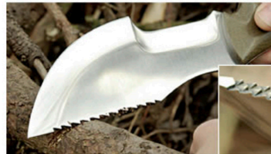
Scharfe Zähne: Die dreireihige Säge des Schanz-Messers beißt sich kraftvoll ins Holz. Sie arbeitet nur in Zugrichtung.
