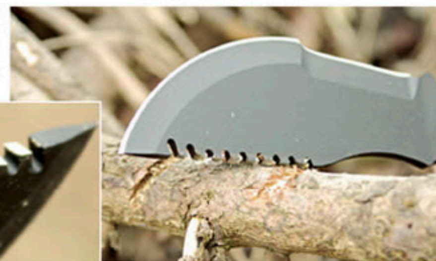
Weniger überzeugend: Die abgeschragten Einzelzähne am TOPS Tracker Knife raspeln eher. Bei dickeren Ästen ist das mühsam.
