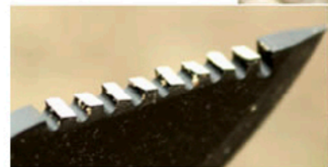
Weniger überzeugend: Die abgeschragten Einzelzähne am TOPS Tracker Knife raspeln eher. Bei dickeren Ästen ist das mühsam.
