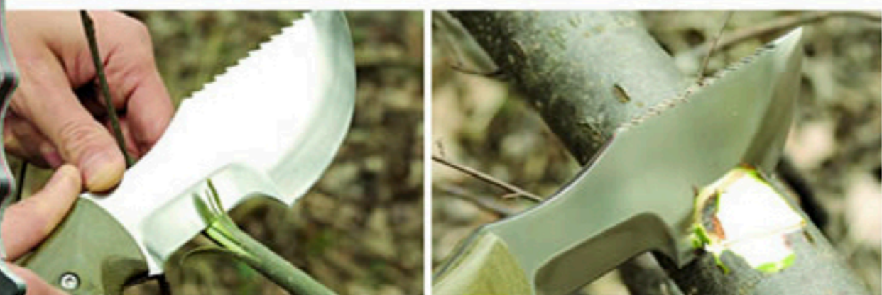
Logischer Schliff: Beim Schanz WSK ist der hintere Klingenbereich hohl geschliffen, der vordere ballig. Das passt zu den Einsatzgebieten – feines Schneiden und Hacken.
