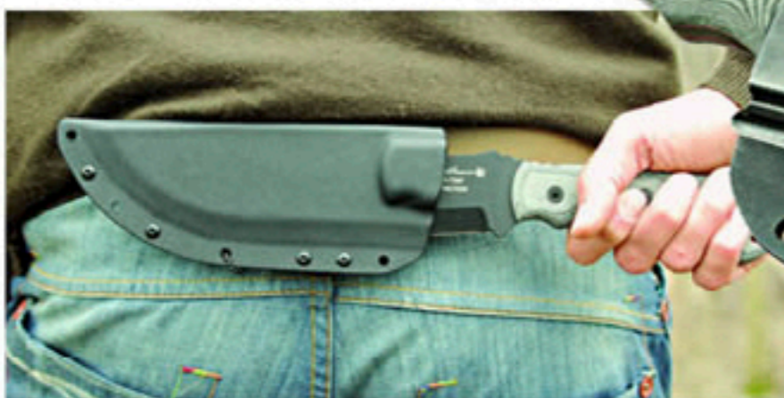
Variabel: Die beiden Klammern an der Kydex-Scheide des TOPS-Modells lassen sich stufenlos verdrehen und an jede Trageweise anpassen.
