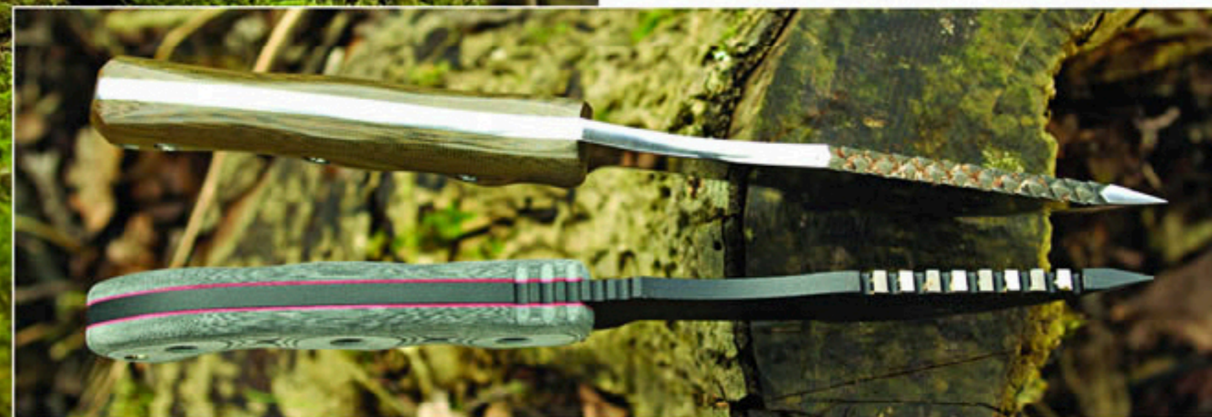
Ungleiche Zwillinge: Das Schanz-Messer (oben) ist etwas länger, der Griff ist dicker. Dafür besitzt das TOPS eine geriffelte Daumenrampe.
